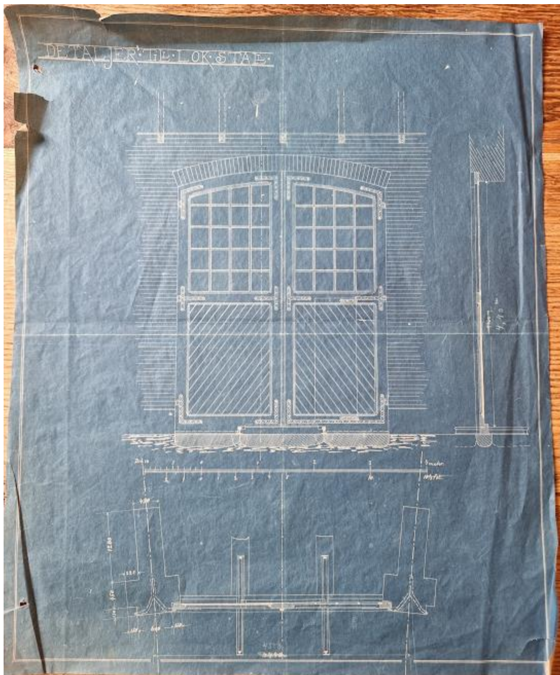
Portritning till lokstallarna. Här ser man också i plan hur gångjärnen är förankrade långt in i murverket. NJM.
