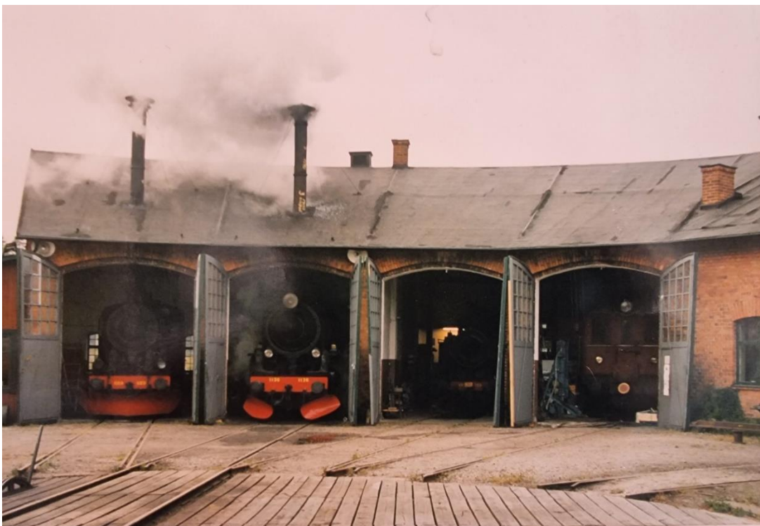
Påeldning vid lokstallet. Loken värms upp så att ångtrycket stiger. Tack vare rökhuvorna kan loken stå kvar i lokstallet utan att lokalen rökfylls. Foto NJM.
